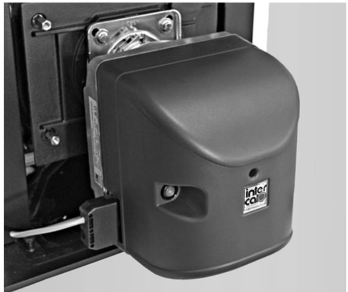
Abb. 4: Am Kesselflansch montierter Brenner
