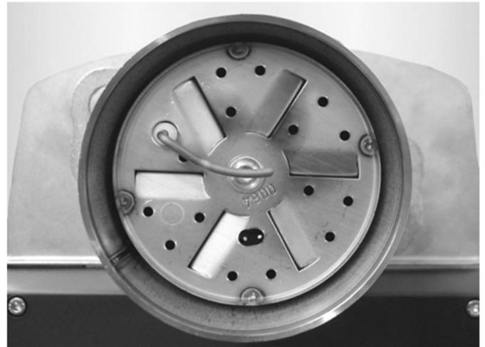
Abb. 18: Position Ionisationselektrode
